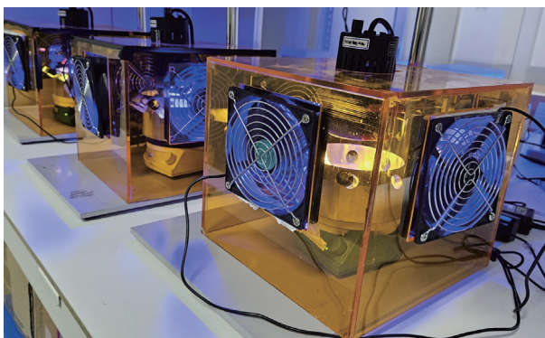
■ (상) 가시광선 광촉매를 활용한 친환경 유기합성법 개발, (하) Blue LED 아래에서 진행되는 광촉매 반응
